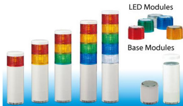
Die LED-Signaltürme der LU7-Serie messen 70 mm im Durchmesser und sind nach dem Baukastensystem aufgebaut. Bis zu fünf stapelbare LED-Module in den Farben Rot, Gelb, Grün, Blau und Transparent/Weiß lassen sich beliebig miteinander sowie mit Klangmodulen oder wartungsarmen, farbigen LED-Stroboskop-Modulen kombinieren.
